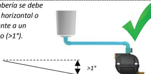
*Si el descenso de la tubería no es suficiente, o si otros problemas del flujo ocurren, un línea de venteo se debe instalar para evitar un bloque de aire.*
