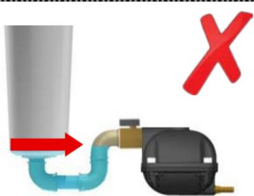
*Recomendamos de aplicar un ½" diametro de la tubería, ½" recodos y un ½" línea de venteo para evitar un bloque de aire.*
