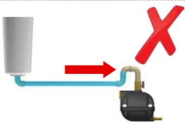
*La ½" tubería se debe instalar horizontal o idealmente a un descenso (>1°).*
