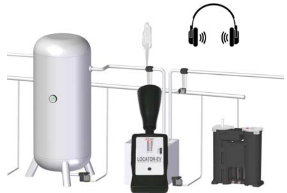
Visuell och hörbar läckageindikering
