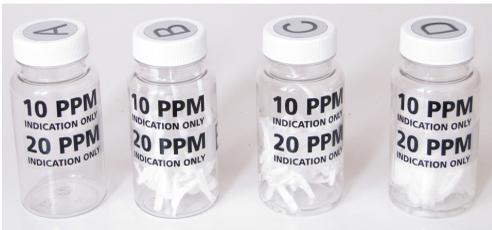
4. Secouez le condensat (0,5L) et rempliez les 4 bouteilles avec condensat. (environ 100ml dans chaque bouteille).
